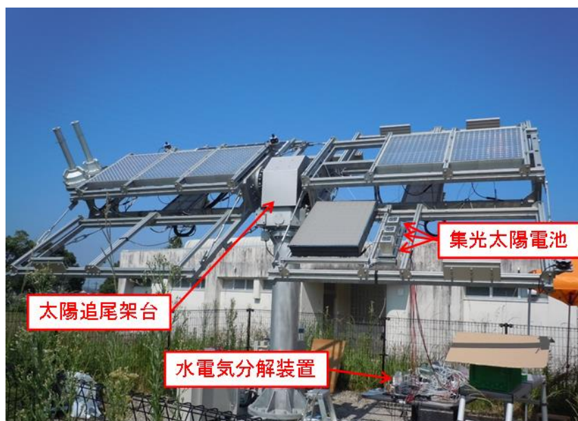
図 3 宮崎大学での水素発生屋外試験に用いた実験装置 太陽光追尾架台に集光型太陽電池を載せ、水電気分解装置と接続した。
