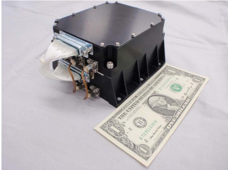
図 2: 超小型衛星「ほどよし4号」に搭載した高速送信機の外観。重量は 1.3 kg、大きさは幅 12 cm、奥行 12 cm、高さ 7 cm。
