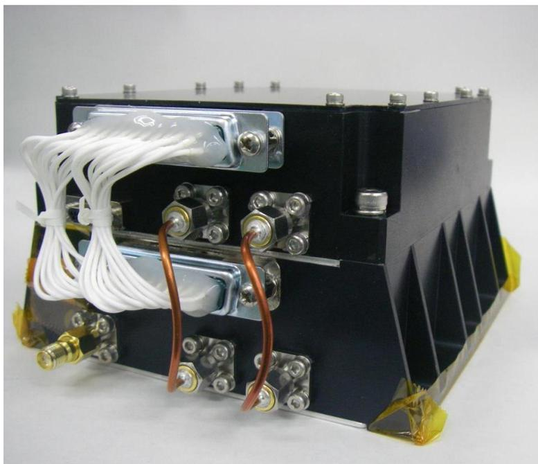
図 1: 超小型衛星「ほどよし 4 号」に搭載した高速送信機の外観。重量は 1.3 kg、大きさは幅 12 cm、奥行 12 cm、高さ 7 cm。
