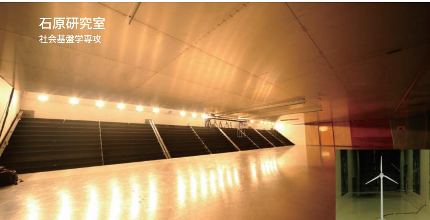
石原研究室では長大橋梁や風力発電設備の耐風性研究を行っています。幅 16m もある全径間風洞設備は、長大橋梁の全橋弾性模型の実験が行える日本唯一の風洞実験設備として我が国の長大橋梁の耐風性研究に貢献してきました。近年急速に発展している風力発電に関する研究も実施しており、日本を代表する 10 社の民間企業と一緒に世界初の浮体式洋上風力発電所を実現しています。(写真) 全径間風洞設備
