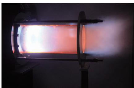
写真2：ガスタービンのバイオマスガス燃焼実験の様子。左の写真では十分な空気量で効率よく燃えている一方、右の写真では空気が多すぎるためにエンジンに振動が起きている。
