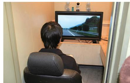
写真1：居眠り防止シート実験の様子。映像によって運転時の状況を再現し、シートの背中に付いたセンサーで脈波を測定する。
