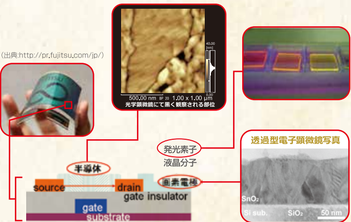
図2 有機ELにも用いられるプリンテッドエレクトロニクス技術
