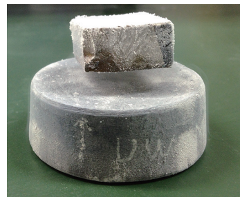
図 高温超伝導物質の「磁束のピン止め効果」。下に置いてある高温超伝導物質との反発により、磁石が浮かんでいる様子。
