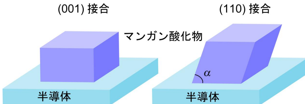
図2 (001)接合と(110)接合でペロブスカイト型マンガン酸化物に生じる格子歪み
