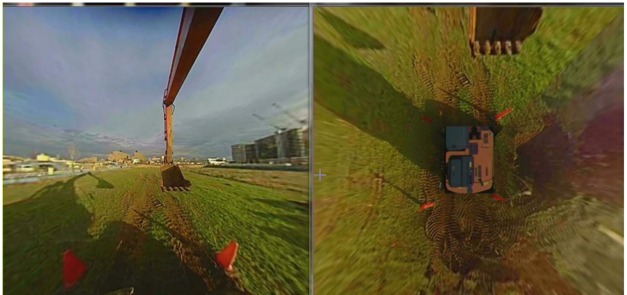
写真 1 前後左右 4 台の魚眼レンズカメラ取付状況
