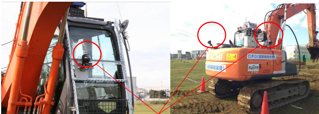
写真 1 前後左右 4 台の魚眼レンズカメラ取付状況
