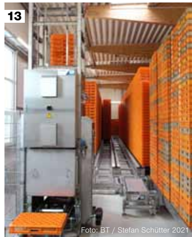
12 Die Weiche unten, am Ende der Lagerbahn, mündet im Zuführband des Kombistaplers. Der Steigförderer dahinter beschickt das Transportband, das zur Kommissionierung führt. 13 Dank der Vorsortierung der Körbe auf der Lagerbahn genügt ein einziger Kombistapler zum Auftürmen der sortenreinen Stapel von hohen und niedrigen Körben. 14 Seit das Logistiksystem im Einsatz ist, ist die Reinigung der Produktion einfacher geworden, weil der Aufsitz-Scheuersaugmaschine dort keine Korbstapel mehr im Weg stehen. 15 Die sauberen Körbe laufen über ein Transportband unter der Hallendecke nach automatischer Anforderung aus dem Lager direkt in die Kommissionierung. 16 In der Kommissionierung mit dem Warenverteilsystem werden fertige Gebäcke, aber auch Getränke, Handelswaren und anderes für die Filialen in die Körbe gepackt.
