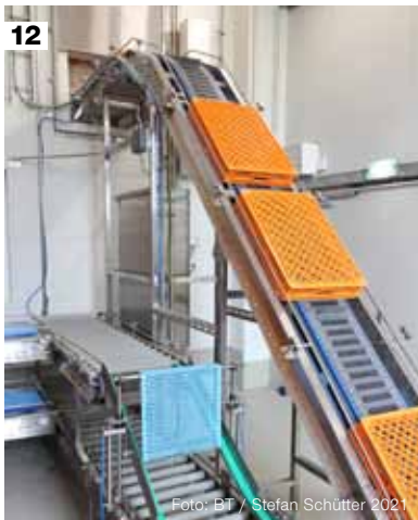
12 Die Weiche unten, am Ende der Lagerbahn, mündet im Zuführband des Kombistaplers. Der Steigförderer dahinter beschickt das Transportband, das zur Kommissionierung führt. 13 Dank der Vorsortierung der Körbe auf der Lagerbahn genügt ein einziger Kombistapler zum Auftürmen der sortenreinen Stapel von hohen und niedrigen Körben. 14 Seit das Logistiksystem im Einsatz ist, ist die Reinigung der Produktion einfacher geworden, weil der Aufsitz-Scheuersaugmaschine dort keine Korbstapel mehr im Weg stehen. 15 Die sauberen Körbe laufen über ein Transportband unter der Hallendecke nach automatischer Anforderung aus dem Lager direkt in die Kommissionierung. 16 In der Kommissionierung mit dem Warenverteilsystem werden fertige Gebäcke, aber auch Getränke, Handelswaren und anderes für die Filialen in die Körbe gepackt.
